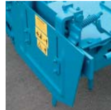
Gefederte Seitenbleche (links) für MKE und M, abgefederte, für Straßen-transport hochklappbare Seitenbleche (rechts) ab PKE und P Spring-loaded side plates (left) for MKE and M. Can be folded upwards for transport PKE & P Tôles latérales montées sur ressorts (à gauche) pour MKE et M, tôles latérales montées sur ressorts et repliables vers le haut pour le transport sur route (à droite) à partir de PKE et P
