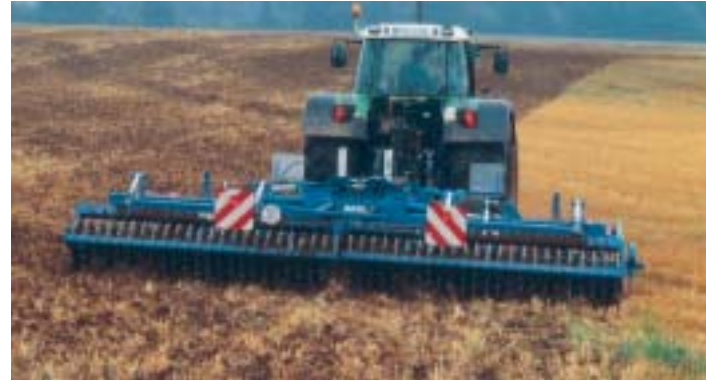
Corvex V 6000 K beim Mulchen von Getreidestoppeln mit auf Griff stehenden Messern Corvex V (6 m) preparing seed bed directly after combining with "on grip" tine position Corvex V 6000 K avec les couteaux pointés vers l'avant réalisant un déchaumage en Technique Culturale Simplifié
