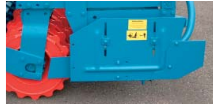
Seitenbleche höhenverstellbar mit optionalen vorderen und hinteren Bodenleitblechen Side plates adjustable in height with optional front and rear soil deflector plates Tôles latérales réglables en hauteur avec en option des tôles déflecteurs avants et arrières
