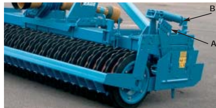
Arbeitstiefeneinstellung (A) über Steckerverstellung am Walzenarm, gefederte Walzenabstützung (B) für steinige Böden Working depth setting (A) via insert adjustment on roller arm. Spring-loaded roller support (B) for stony conditions Réglage de la profondeur de travail (A) par broches sur les bras du rouleau, rouleau monté sur ressorts de rappel (B) pour une sécurité anti-pierres très efficace
