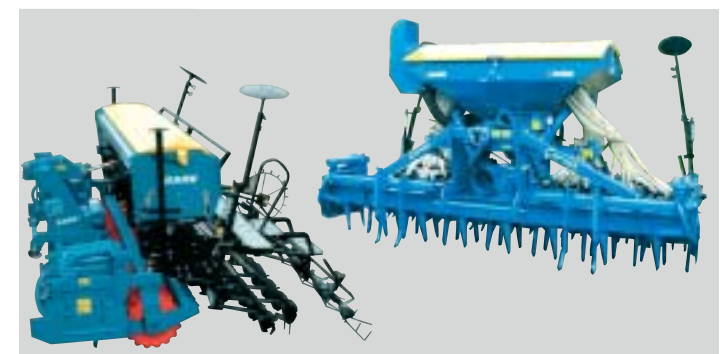
Aufbau von Drillmaschinen direkt auf die Walze (links) oder Kopplung über Satteldreieck (rechts) Drills are mounted on the packer roller (lh) or by means of A-frame Adaptation de semoirs directement sur le rouleau (à gauche) ou par l'intermédiaire d'un attelage triangle (à droite)
