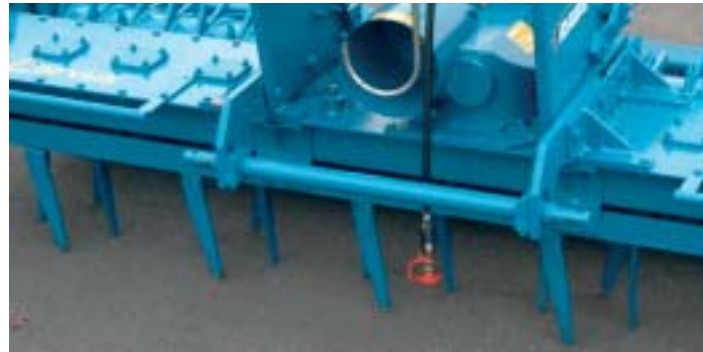
Verstellbare Unterlenkerachse für Kat. 2, 3 oder 3 kurz Adjustable lower link bar for Cat. 2, 3 or 3 short (N) Barre d'attelage réglable pour cat. 2, 3 ou 3 court
