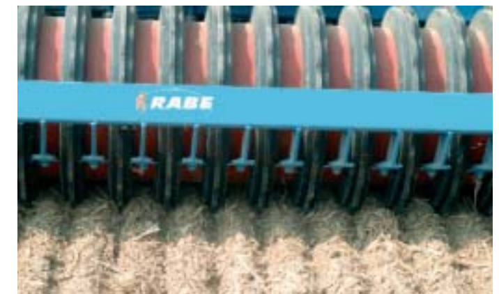
(Mulch) Rillenpackerwalze (60 cm Ø) für ganzflächig rillenbetonte Rückverfestigung (Mulch) wedge ring roller (60 cm Ø) for overall width consolidation in ridges Rouleau sillonneur (Ø 60 cm) pour un rappuyage homogène avec rappuy optimisé des sillons
