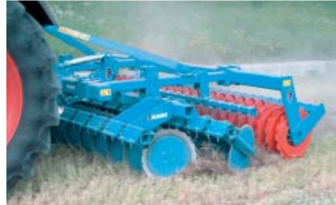
Aggressiv arbeitende Hohl­scheiben für intensive Mulcharbeit Aggressive action of discs for intensive mulching Action agressive des disques incurvés pour un mélange intensif paille-terre
