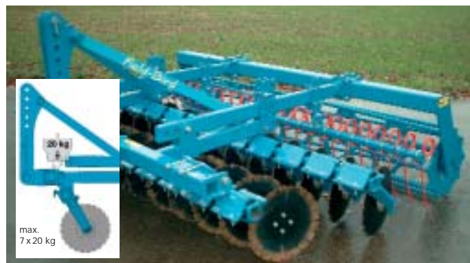
Tiefenführung über Schlepper und Walze Depth control by tractor and roller Contrôle de profondeur par le relevage et le rouleau
