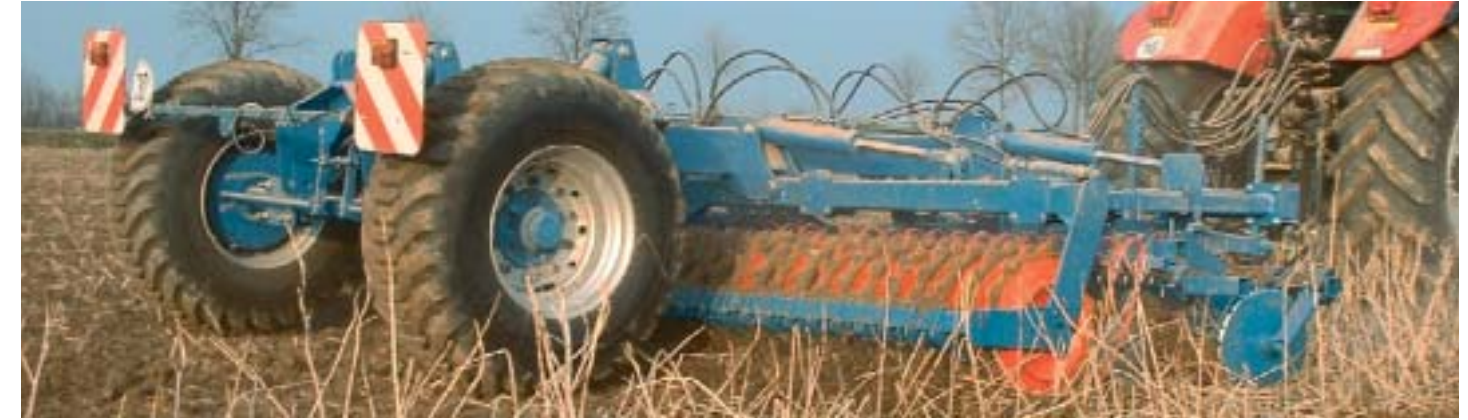
Fahrwerk mit Anbaumöglichkeit für zusätzliche Geräte Chassis with hitch for rear mounting of implements Châssis permettant d'adapter d'autres outils à l'arrière
