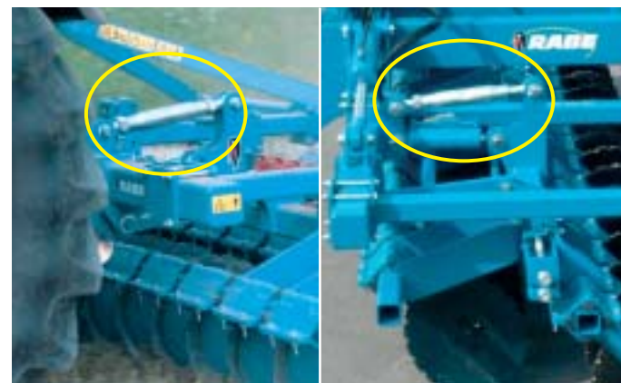
Änderung der Arbeitstiefe von 1. und 2. Reihe über Spannschlossverstellung Depth alignment of first and second disc gang Réglage de la profondeur de travail de la 1 ère rangée par rapport à la 2 ème
