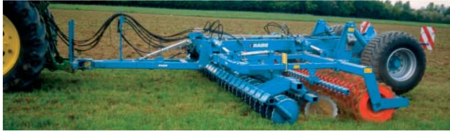
Mulchscheiben, Striegel, Packerwalze, Fahrwerk Mulch discs, trash harrow, packer roller, chassis Disques mulcheurs, peigne, rouleau, chariot de transport
