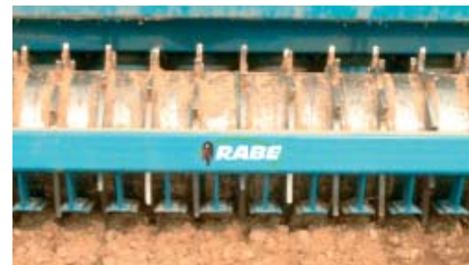
Zahnpackerwalze (51 cm oder 66 cm Ø) für ganzflächige Rückverfestigung Toothed packer roller (51 cm or 66 cm Ø) for overall width consolidation Rouleau packer (Ø 51 cm ou 66 cm) pour un rappuyage homogène
