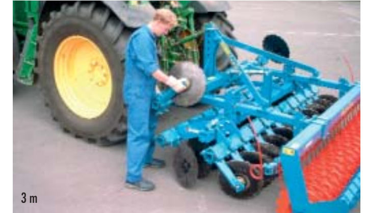
Umstecken der Randscheiben und Randstriegel für Straßentransport Conversion of end discs and end tines for transport Demontage aisé du disque de bordure et du peigne extérieur pour le transport
