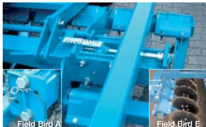
Horizontales Verschieben der Scheibenreihen bei Tiefen- und Tempoänderung Sideshift of disc gang Les deux trains de disques coulissent sur la largeur pour régler leur recroisement
