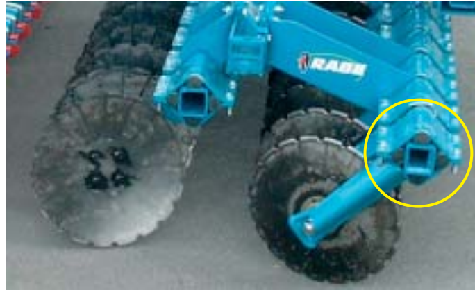
Gezackte Mulchscheiben (Ø 46 cm) mit Rabeflex-Federung Serrated mulching discs (Ø 46 cm) with Rabeflex sprung Disques mulcheurs crénelés et incurvés (Ø 46 cm) montés sur suspensions Rabeflex
