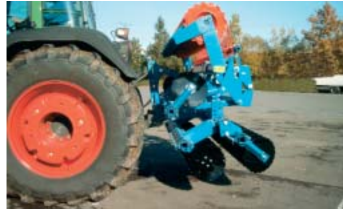
leichtes Ausheben durch Hochklappen der Walze (3000 H) close center of gravity due to rear lifting of roller relevage aisé par basculement du rouleau sur l'appareil
