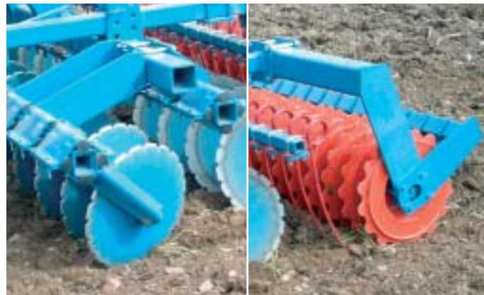
Gezackte Mulchscheiben Serrated discs Disques crénelés et incurvés
