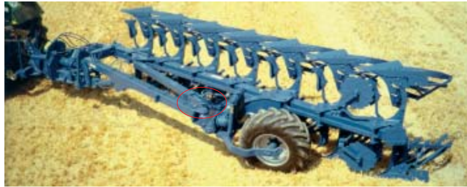
Stufenlose hydraulische Arbeitsbreitenverstellung von 33 cm bis 53 cm Hydraulic working width adjustment from 33 cm to 53 cm Réglage progressif hydraulique de la largeur de travail de 33 à 53 cm
