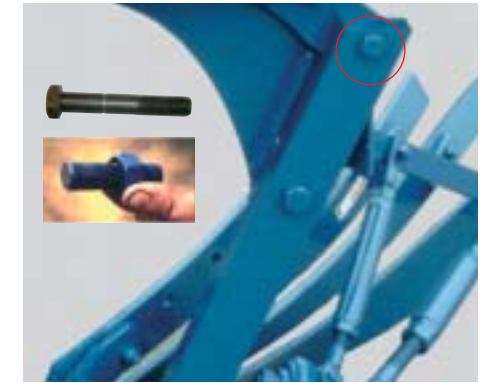
Scherschraube mit Abrissnut für genaues, sauberes Abscheren Shear bolt with shear groove for exact, clean shearing Boulon de sécurité avec gorge de cisaillement pour une sécurité efficace de tous les étançons
