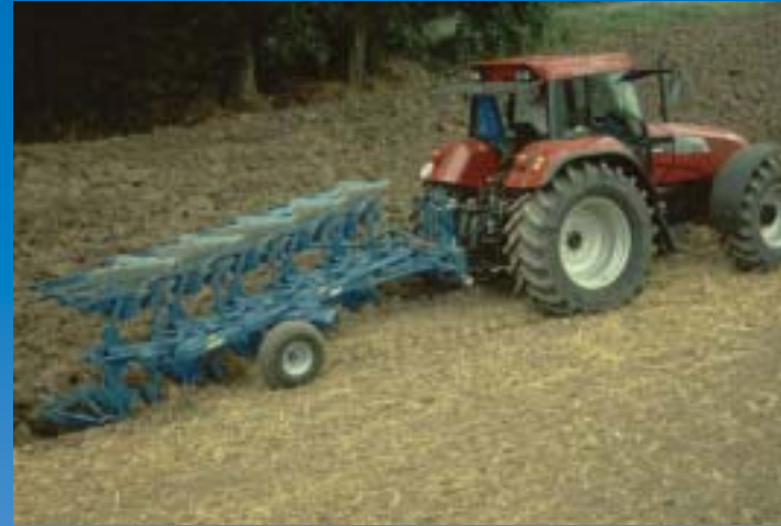
Anbaudrehpflüge mit hydr. Steinsicherung oder Scherschraubensicherung Mounted reversible ploughs with hydr. stone protection or shear bolt protected Charrues réversibles avec sécurité Non-Stop hydr. ou avec sécurité boulon de cisaillement
