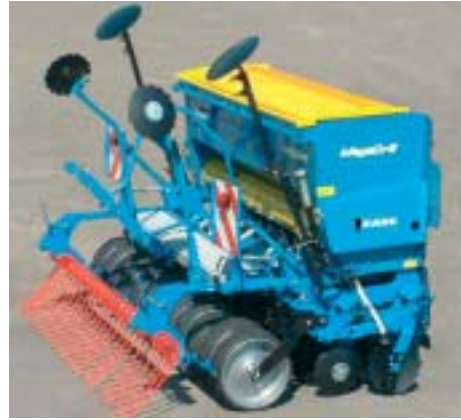
Möglichkeiten des Anbaus der MegaDrill an den angehängten Scheibenmulcher Field Bird Option of mounting the MegaDrill onto the rear linkage of Field Bird disc tiller Possibilités d'atteler le MegaDrill aux déchaumeurs à disques semi-portés Field Bird
