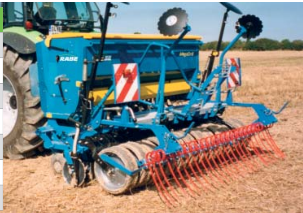
Je zwei Scheibenschare werden über ein Parallelogramm von einer Andruckrolle exakt in der Tiefe geführt Two seed coulters are linked with one press wheel by means of a parallelogram device for depth control Deux éléments semeurs à disques sont chaque fois reliés à une roue plombreuse par l'intermédiaire d'un parallélogramme pour un contrôle précis de la profondeur
