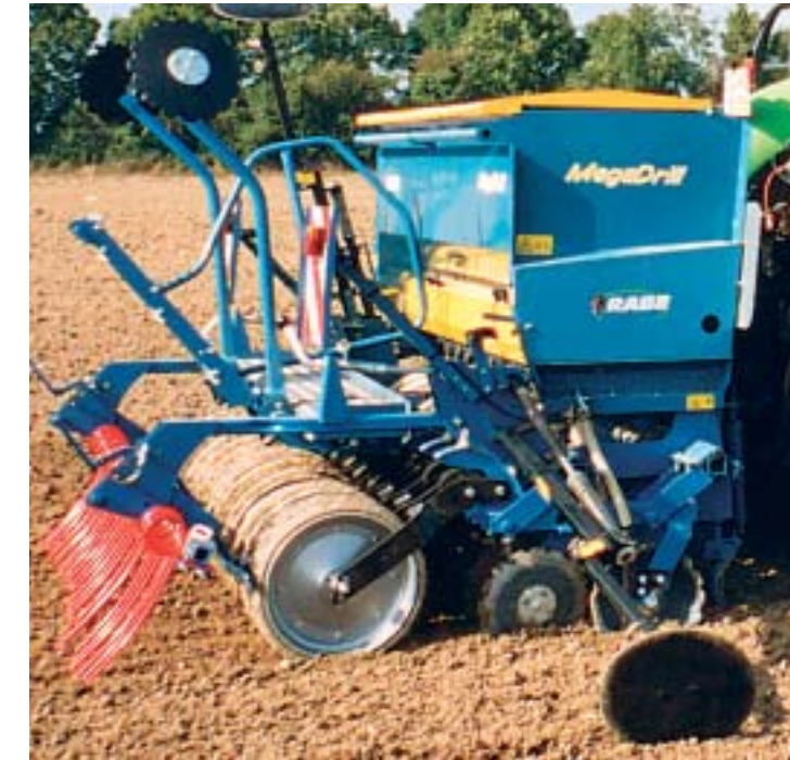
Hoher Schardruck (50 kg) für große Arbeitsgeschwindigkeit (bis 15 km/h) 50 kg coulter pressure for high working speed of 15 km/h Force de terrage élevée (50 kg) pour permettre de grandes vitesses de semis jusqu'à 15 km/h
