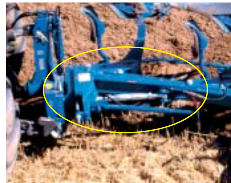
Kompaktes Einstellzentrum mit Spannschloß Compact adjustment centre with turnbuckle Centre de réglage compact avec tirant de réglage
