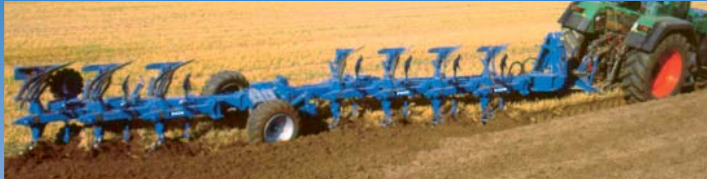
Aufsatteldrehpflüge Marabu, 6-furchig bis 10-furchig Marabu semi-mounted reversible ploughs, 6 furrows to 10 furrows Charrues semi-portées Marabu, 6 à 10 socs
