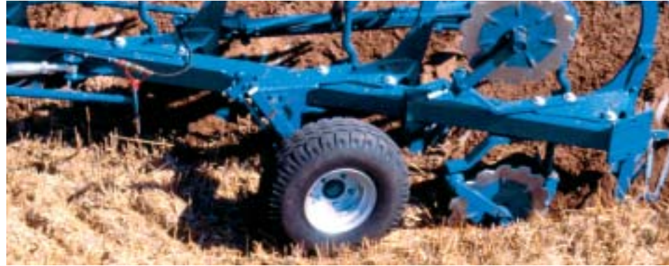
Tastrad für gleichmäßige Tiefenführung mit Anschlagpuffer und Gelenk an Tastradstiel, kann weiter vorne oder hinten montiert werden Depth wheels for even depth control with damper and joint on wheel stalk, can be mounted further forward or rearward Roue de terrage pour un contrôle régulier de la profondeur de labour, avec butée amortisseur et articulation sur la tige de roue, elle peut être déplacée vers l'avant ou l'arrière sur le bâti
