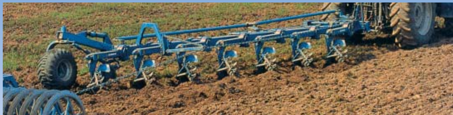
Aufsattelbeetpflüge Milan, 6-furchig bis 8-furchig Milan semi-mounted conventional ploughs, 6 furrows to 8 furrows Charrues semi-portées en planche Milan, 6 à 8 socs
