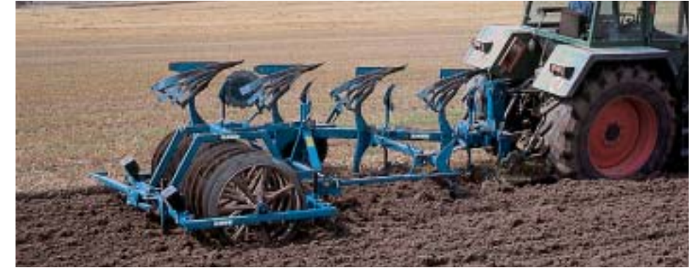
Packer im Einsatz Packer in operation Rouleau plombé au travail
