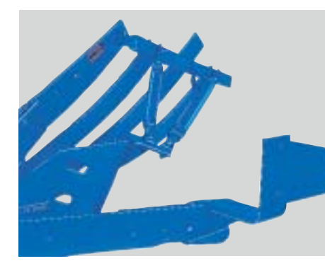
Breitfurchenmesser für letzten Körper bei Breitbereifung des Schleppers (plus ca. 18 cm) Furrow cutters for wider tyres (plus approx. 18 cm) Couteau élargisseur de raie adaptable sur le dernier corps pour labours avec pneus larges (dernière raie élargie d'env. 18 cm)
