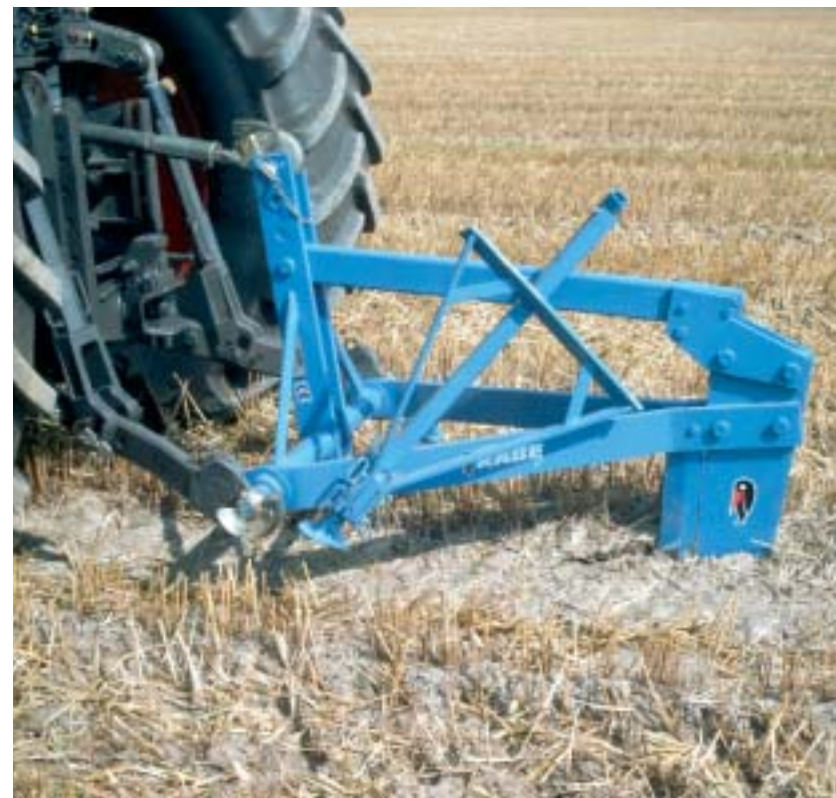
Zinken mit austauschbarer Schneide Tine with exchangeable cutting edge Dent avec lame interchangeable
