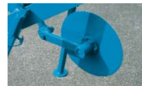
Scheibensech (40 cm), Einsatz bei langen Ernterückständen Disc coulters are recommended under heavy trash conditions Couteur circulaire (40 cm), pour débris végétaux importants
