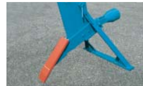
Kegel für Maulwurfs-Drainage Cone for mole draining Cône draineur
