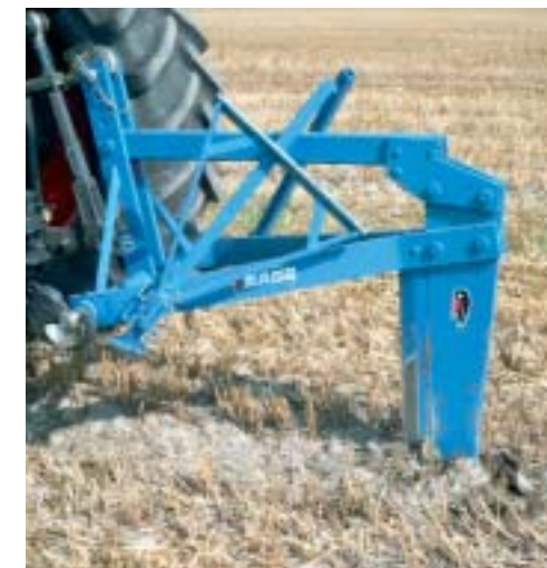
Zinken mit austauschbarer Schneide Tine with exchangeable cutting edge Dent avec lame interchangeable
