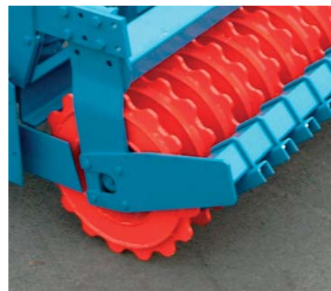
Mulchpackerwalze MPW 500, Stahlwalze mit ausschließlich rillenförmiger Rückverfestigung, durch Wellenringe besonders geeignet für gemulchte Böden
