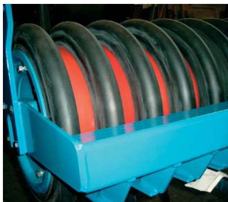
Rillenpackerwalze RIPA für ganzflächige, rillenbetonte Rückverfestigung RIPA Wedge ring roller for overall consolidation in enhanced grooves
