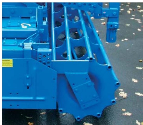
Stabpackerwalze RSW 540, leichte Walze mit Rückverfestigung in Querrillen
