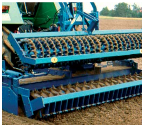
Crosskillwalze C 440 als zusätzliche Krümelwalze im hydraulischen Dreipunktgestänge C 440 Crosskill roller as additional crumbler roller in hydraulic three-point linkage
